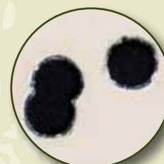
Schussbild mit 3 Schuss 9.3x62 auf 100 m. 3-shot 9.3x62 test fire group at 110 yards.
