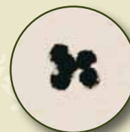
Schussbild 1517 D 5 Schuss .17 HMR auf 100 m. 5-shot 1517 D .17 HMR test fire group at 110 yards.
