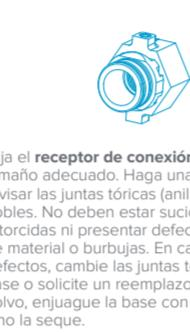
2 Elija el receptor de conexión rápida del tamaño adecuado. Haga una pausa para revisar las juntas tóricas (anillos de sellado) dobles. No deben estar sucios con polvo, retorcidas ni presentar defectos como falta de material o burbujas. En caso de defectos, cambie las juntas tóricas de otra base o solicite un reemplazo. En caso de polvo, enjuague la base con agua corriente y no la seque.
