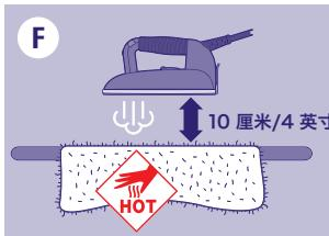
请勿使用防护底板 (10) 熨烫马海毛、羊绒、丝绒、安哥拉兔/羊毛。熨烫这类衣物时, 请在距离约10cm/4英寸处喷洒蒸汽, 以防止织物纤维粘结。接着, 将衣物拿起抖动, 使其恢复初始状态。⑥
