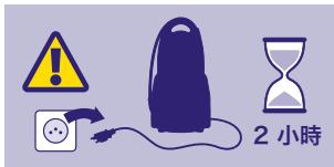
**注意: 在清潔前必須確保燙斗已關閉, 切斷電源並完全冷卻。關閉設備並從插座上拔出插頭。讓設備冷卻最少2小時。建議於使用前清潔設備。**
