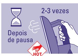
**IMPORTANTE:** Antes de começar a passar a roupa ou depois de uma pausa prolongada, pressione 2 ou 3 vezes o botão de vapor do ferro, afastando o ferro da roupa, para evacuar a condensação e evitar manchas de água na roupa.
