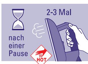
**HINWEIS:** Bevor Sie mit dem Bügeln beginnen bzw. nach einer längeren Pause drücken Sie zwei oder drei Mal auf die Dampftaste des Bügeleisens und halten Sie es von der Kleidung weg. Dadurch wird das Kondensationswasser des Bügeleisens freigesetzt, und es werden Wasserflecken auf der Kleidung verhindert.
