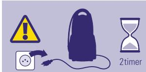
**ADVARSEL: TAG STIKKET UD før rengøring, SLUK apparatet og lad det KØLE AF. Sluk apparatet og tag stikket ud af stikkontakten. Lad apparatet køle af i mindst 2 timer.**
