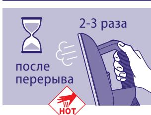
**ПРИМЕЧАНИЕ.** До начала глажения или после продолжительной паузы нажмите 2-3 раза на кнопку пара на утюге, не направляя его на бельё, чтобы удалить скопившийся конденсат и избежать пятен воды на одежде.
