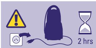
**OSTRZEŻENIE:** Przed czyszczeniem urządzenie musi być wyłączone, odłączone od zasilania i zimne. Należy pozostawić urządzenie na co najmniej 2 godziny do ostygnięcia. Najlepiej wyczyścić urządzenie przed jego użyciem.
