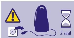
**UYARI:** Cihaza temizlik müdahalesında bulunulmadan önce, cihazın **FİŞİNİN PRİZDEN ÇEKİLMİŞ, KAPALI** ve **SOĞUK** olması gerekmektedir. Cihazı kapatarak fişi prizden çekiniz. Cihazın en az 2 saat soğumasını bekleyiniz. Cihazın kullanım **ÖNCESİNDE** temizlenmesi tercih edilir.
