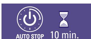
**IMPORTANTE:** Para seu conforto e segurança, o ferro de passar com vapor Laurastar se desliga automaticamente passados 10 minutos sem utilização.
