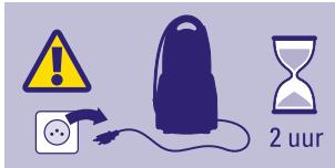
**WAARSCHUWING:** stel het toestel **VOLLEDIG BUITEN WERKING** alvorens u het gaat reinigen! Schakel het toestel uit en neem de stekker uit het stopcontact! Laat het toestel ten minste 2 uur afkoelen. U mag het toestel uitsluitend reinigen als het koud is, het best **VOOR** gebruik!
