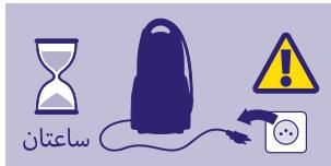
**تنبيه: قبل تنظيف الجهاز، إطفاء الجهاز وفصل شريط الكهرباء! ترك المكواة تبرد ما لا يقل عن ساعتين. التنظيف فقط عندما تكون المكواة باردة، والأفضل قبل الإستعمال!**
