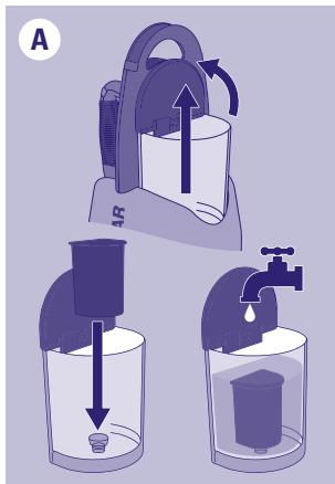
**IMPORTANTE:** Encha sempre e completamente o reservatório com água para obter um funcionamento correto do aparelho.
