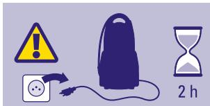
**AVERTISSEMENT :** avant tout nettoyage, DÉBRANCHEZ, ÉTEIGNEZ et laissez l'appareil REFROIDIR. Éteignez l'appareil et débranchez la prise électrique de la prise murale. Laissez votre appareil refroidir au moins durant 2 heures. Le nettoyage s'effectue de préférence AVANT l'utilisation.
