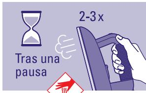
**NOTA:** Antes de empezar a planchar o después de una pausa prolongada, pulse 2 o 3 veces el botón del vapor de la plancha a cierta distancia de la ropa, con el fin de evacuar la condensación de la plancha y de evitar manchas de agua sobre las prendas.
