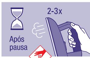
**IMPORTANTE:** Antes de começar a passar a roupa ou depois de uma pausa prolongada, pressione 2 ou 3 vezes o botão de vapor do ferro, afastando o ferro da roupa, para evacuar a condensação e evitar manchas de água na roupa.
