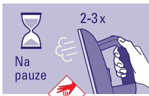
**LET OP:** voordat u met het strijken gaat beginnen of na een lange onderbreking, drukt u 2 of 3 keer op de stoomknop van het strijkijzer maar niet in de richting van het wasgoed. Zo wordt alle condensatie uit het strijkijzer afgevoerd en worden watervlekken op het wasgoed voorkomen.
