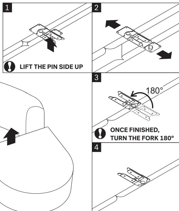
**!** LIFT THE LEFT SIDE OF THE SEAT TO DETACH THE CLIPS AND DISCONNECT THE ITEMS
