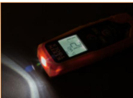
Pantalla LCD retroiluminada y linterna incorporada
