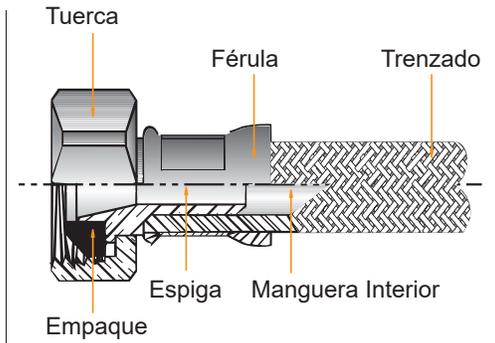
\*Trenzado en Vinilo Reforzado color Platino, que brinda una alta resistencia a la corrosión ambiental y un estético diseño con acabado metálico. Evite el contacto con productos químicos y agentes corrosivos.
