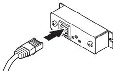
3. **Raccordez l'autre connecteur à un concentrateur, un routeur ou un appareil similaire.**
