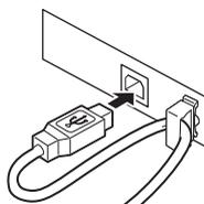
3. **Insérez solidement l'autre connecteur dans le port de l'interface de l'ordinateur hôte.**
