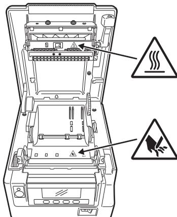
**CETTE ÉTIQUETTE SIGNALLE LE RISQUE DE BRÛLURES LIÉES À LA TEMPÉRATURE ÉLEVÉE DE LA TÊTE D'IMPRESSION ET LE RISQUE DE COUPURES OCCASIONNÉES PAR LES MÉCANISMES DE DÉCOUPE MANUELS ET AUTOMATIQUES LORSQUE LE CAPOT DU PAPIER EST OUVERT.**
