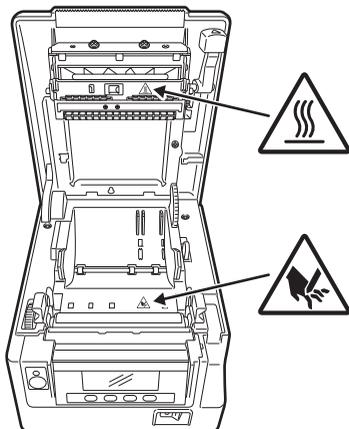
**DIESER AUFKLEBER WEIST DARAUF HIN, DASS BEI GEÖFFNETER PAPIERABDECKUNG VERBRENNUNGSGEFAHR DURCH HOHE TEMPERATUREN AM DRUCKKOPF SOWIE DIE GEFAHR VON SCHNITTVERLETZUNGEN DURCH DEN MANUELLEN UND AUTOMATISCHEN PAPIERSCHNEIDER BESTEHT.**
