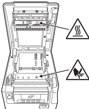
ESTA ETIQUETA INDICA QUE EXISTE RIESGO DE SUFRIR QUEMADURAS DEBIDO A LAS ALTAS TEMPERATURAS DEL CABEZAL DE IMPRESIÓN, ASÍ COMO RIESGO DE SUFRIR CORTES POR LAS CIZALLAS MANUALES Y AUTOMÁTICAS MIENTRAS LA TAPA DEL PAPEL ESTÁ ABIERTA.
