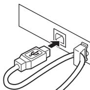
3. **Inserte el otro conector firmemente en el puerto de interfaz de del ordenador host.**
