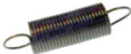
SPRING TENSION L0=20.2MM/ OD=5.5MM/ C=0,208N/MM/ [5 PCS.] FEDER ZUG L0=20,2MM/ AD=5,5MM/ C=0,208N/MM/ [5 STK.] 46408053
