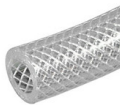
HOSE PVC/TEXTILE/ OD=20MM/ ID=13MM/ P=12BAR/ G1/2" SCHLAUCH PVC/GEWEBE/ AD=20MM/ ID=13MM/ P=12BAR/ G1/2" 47601301
