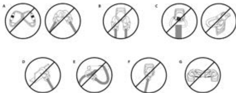
Figura 4 - Conexiones no compatibles
