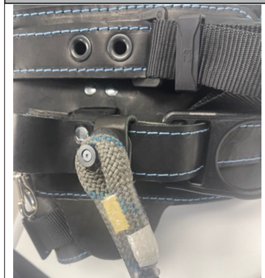
Figura 5: Ubicación óptima del retenedor magnético
