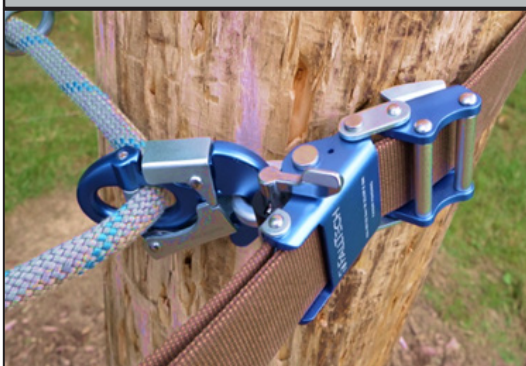
Figura 11: Ajuste adecuado en el costado del ajustador de la correa
