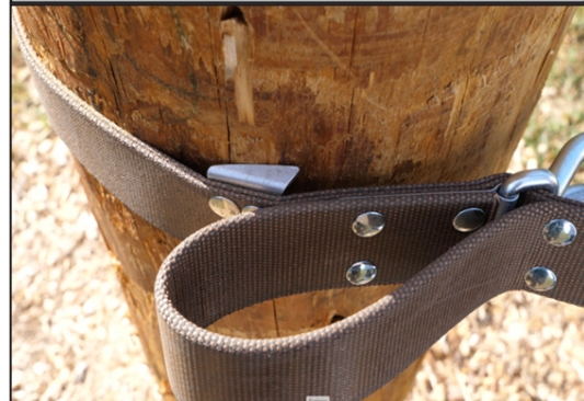
Figura 12: Ajuste adecuado del costado de la correa tejida fija
