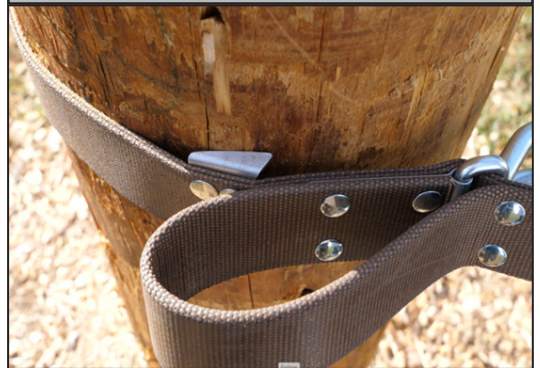
Illustration 12 : Ajustement correct du côté de la sangle en toile fixe
