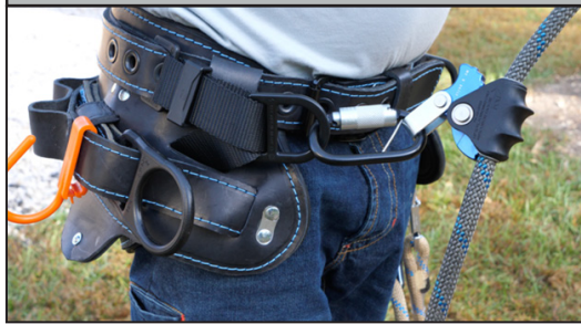
Figura 4: Conectar el dispositivo al cinturón de cuerpo
