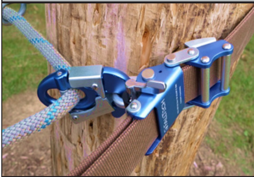
Illustration 11 : Ajustement correct du côté de l'ajusteur de sangle
