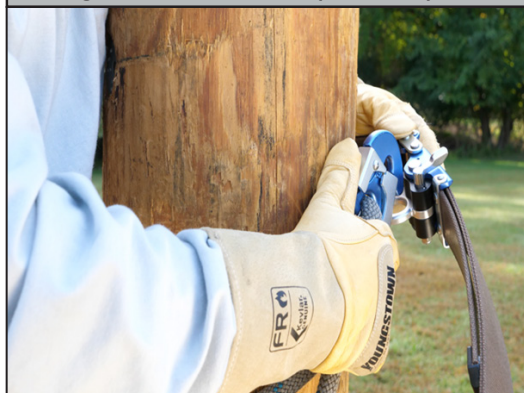
Figura 6: Conexión del dispositivo al poste
