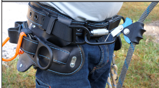
Illustration 4 : Connexion de l'appareil à la ceinture corporelle
