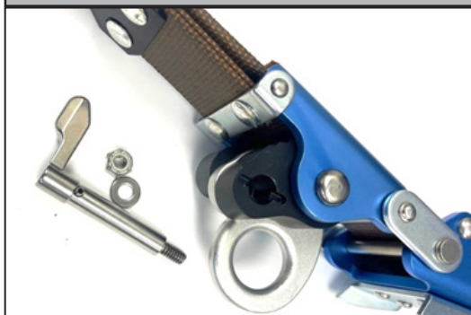
Illustration 29 : Démontage du dégagement au pouce
