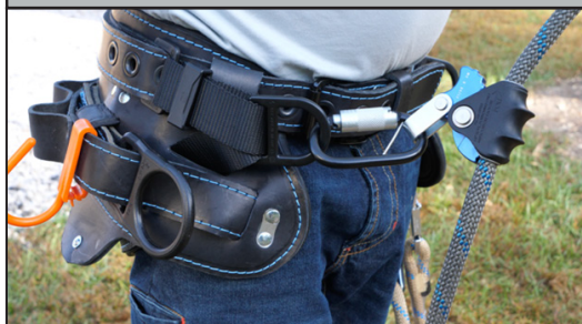
Figura 4: Conectar el dispositivo al cinturón de cuerpo
