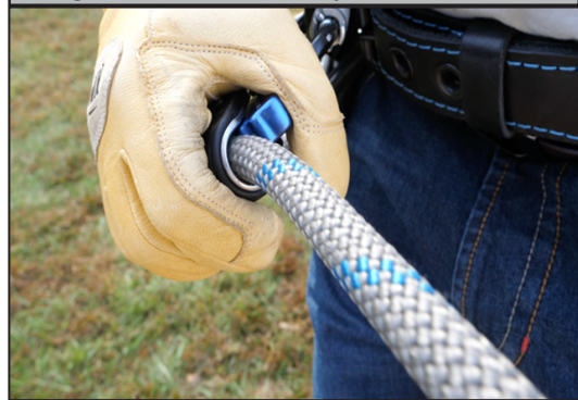
Figura 16: Liberación del ajustador de cuerda
