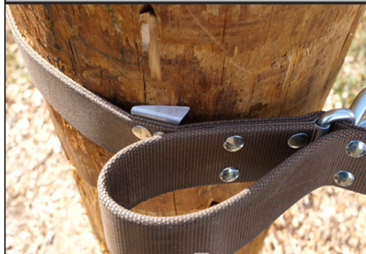
Illustration 12 : Ajustement correct du côté de la sangle en toile fixe
