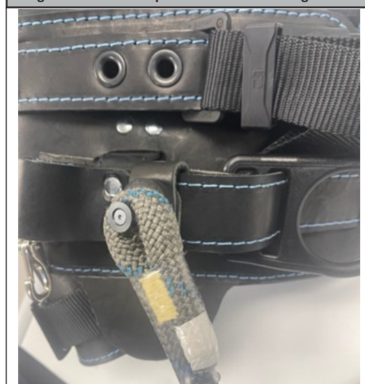
Figura 5: Ubicación óptima del retenedor magnético
