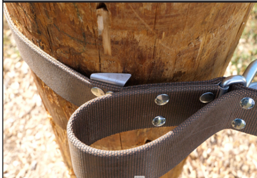
Figura 12: Ajuste adecuado del costado de la correa tejida fija
