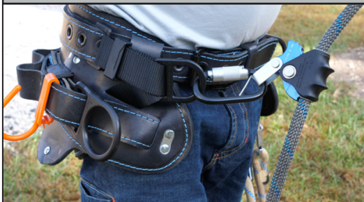
Illustration 4 : Connexion de l'appareil à la ceinture corporelle
