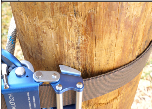
Figura 9: Escalada suave con listón horizontal
