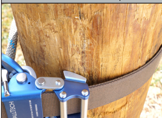
Illustration 9 : Escalade en douceur du taquet horizontal
