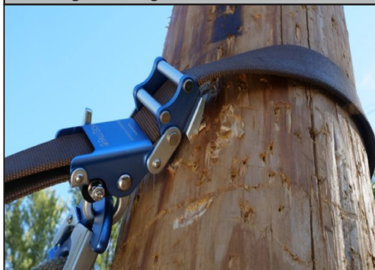
Figura 10: Enganche de listón vertical
