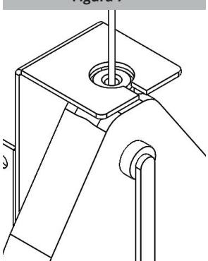
1. Retire el perno y la arandela del soporte y doble hacia abajo la solapa inferior como se muestra en la Figura 6.
