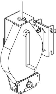
3. Alinee el orificio de la SRL-R con la abertura circular en el soporte e insértelo a través del soporte como se muestra en la Figura 15.
