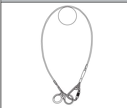
Figure 14 - Installation de l'ancre d'étranglement
